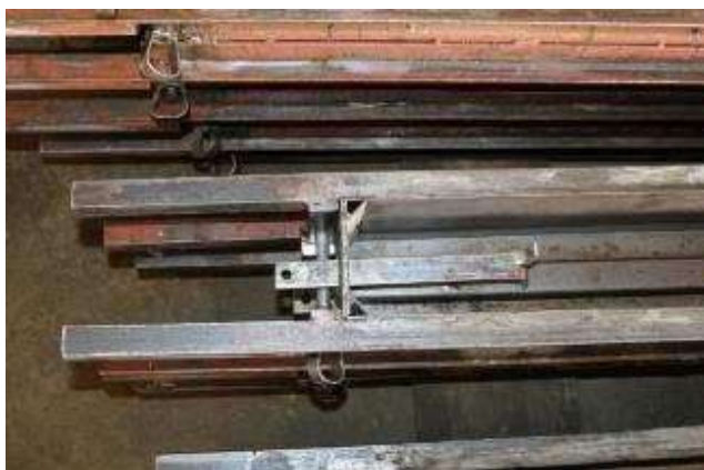
Figura 40 – Varillas de acero CA-60 de \varnothing 5 mm y plancha metálica.
