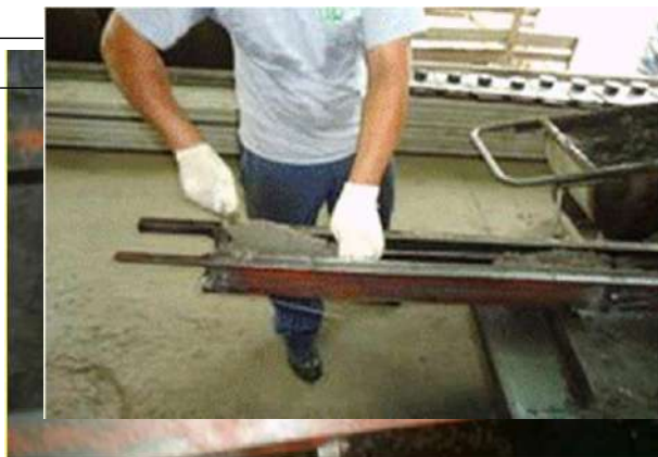
Figura 31 – Colocación de la primera capa de hormigón en el encofrado metálico.
