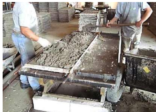
Figura 18 – Colocación manual de la segunda capa de hormigón.
