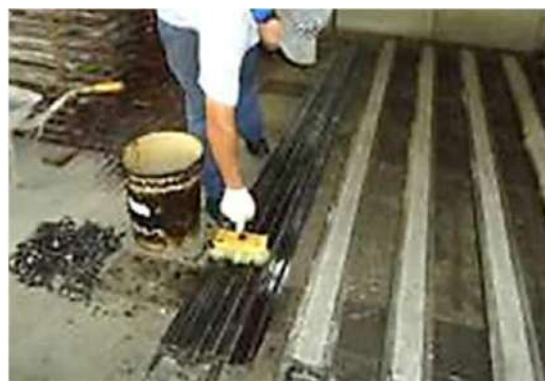
Figura 26 – Aplicación del desmoldante.
