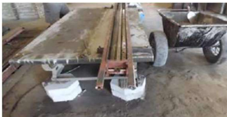
Figura 37 – Molde metálico para pilares prefabricados en hormigón armado.
