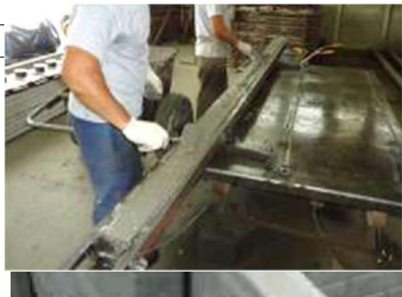
Figura 32 – Colocación de la segunda capa de hormigón en el encofrado metálico.
