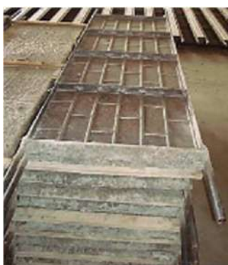
Figura 13 – Encofrado metálico destinado a la producción de cuatro paneles de cerramiento.
