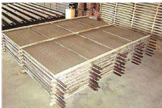
Figura 21 – Apilado de los encofrados para el proceso de curado.
