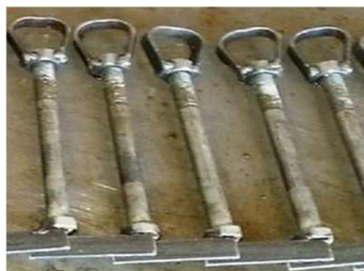
Figura 24 – Tornillos de los encofrados metálicos.
