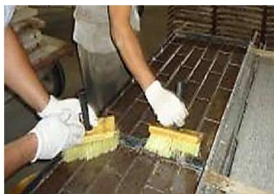
Figura 14 – Aplicación del desmoldante.
