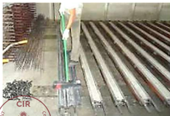
Figura 25 – Limpieza de los encofrados.
